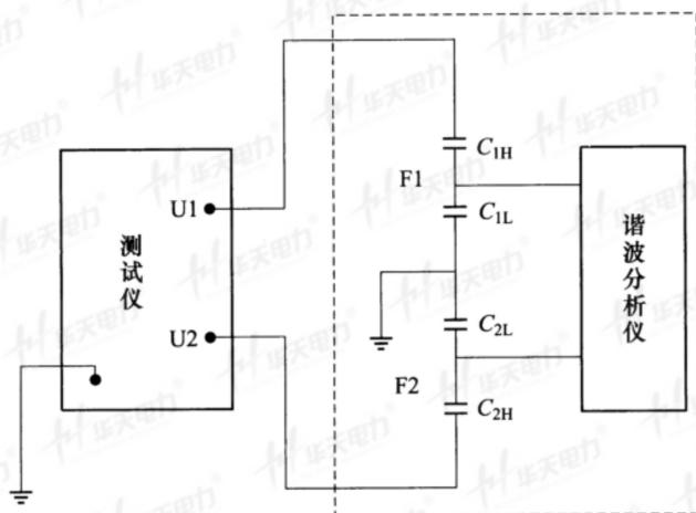
图 2 谐波总含量测量原理图
