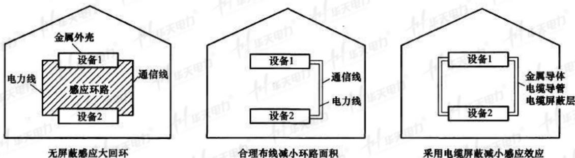
图 4 减小线路回环中感应效应
