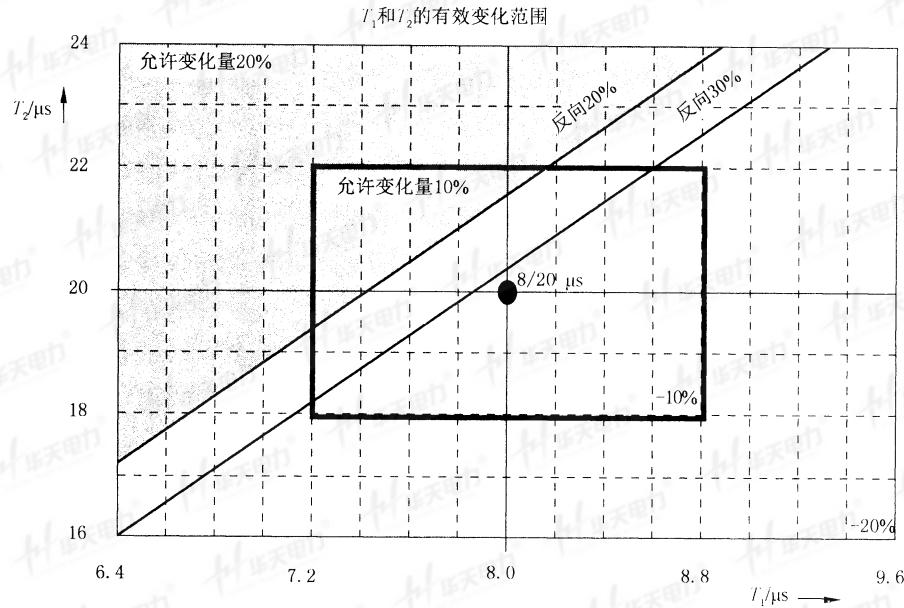
图 E.1 最大反向过冲为 20%,时间参数变化允许范围为 20% 的
