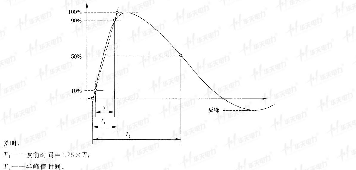
图 18 指指数型冲击电流波形
