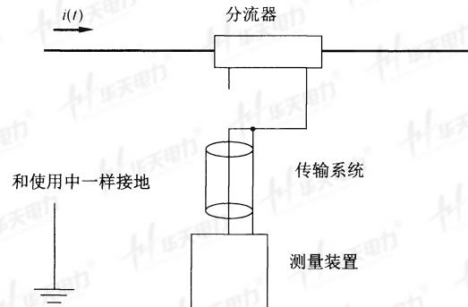
图 11 干扰试验电路原理图
