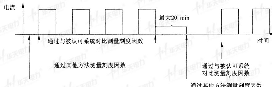
图 8 周期脉冲电流和周期短时电流的短时稳定性试验
