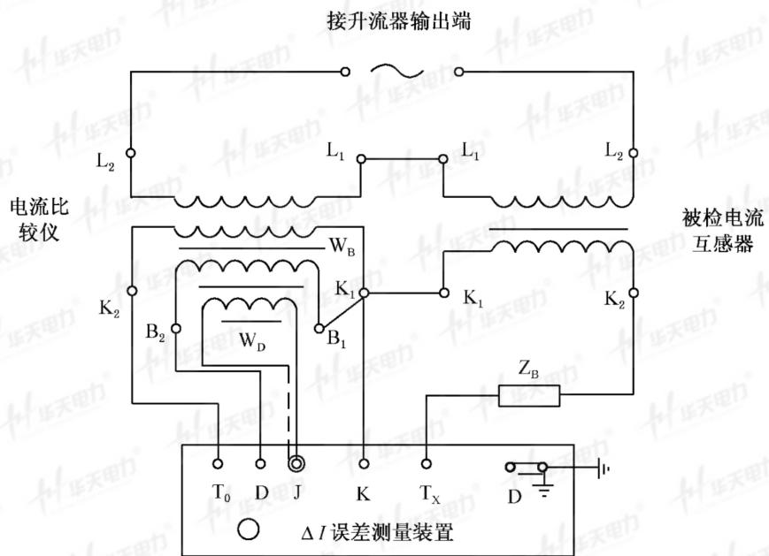
图 4 电流比较仪检定电流互感器线路
