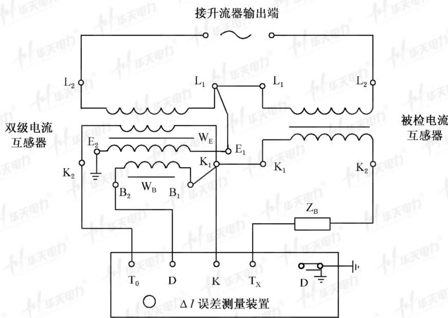
图 8 一次补偿绕组接地线路
