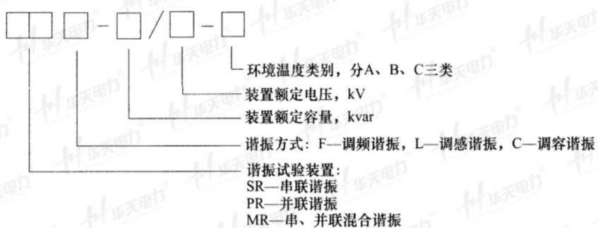
图 1 谐振试验装置的型号命名规则
