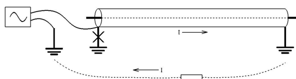
图 5- 7 护层-大地接法信号流向示意图
