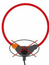
图 6- 19 易对柔性线圈产生干扰区域
